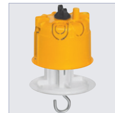
Nouvelle boîte DCL pour point de centre : - bornes automatiques, orientées à 45° - plus de volume Ø67 mm - couvercle plus discret
