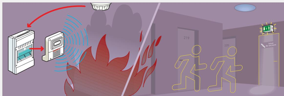
En cas de déclenchement de l'alarme incendie, les BAES d'évacuation des blocs [BAES + BAEH] passent en fonctionnement de sécurité, permettant ainsi l'évacuation des personnes en toute sécurité.
