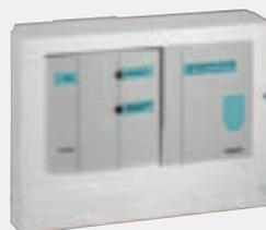
Le détecteur autonome déclencheur (DAD) permet, à partir de un ou deux détecteurs automatiques d'incendie identiques, d'assurer localement une fonction, soit de compartimentage, soit de désenfumage. Il s'intègre à un SSI de catégorie B, C, D ou E, et A uniquement pour la mise en sécurité des centrales de traitement d'air. Il peut commander jusqu'à trois DAS uniquement par rupture de courant.
