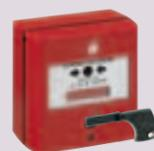
Il permet une visualisation claire et rapide de son état (actionné ou en veille). Le déclencheur manuel adressable est équipé d'un indicateur mécanique et d'un voyant lumineux. L'indicateur mécanique renseigne sur l'état du déclencheur (actionné ou en veille) et le voyant indique si la centrale a pris en compte ou non l'information.
