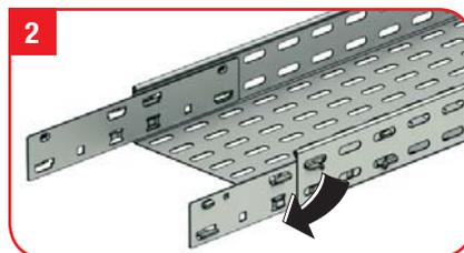
ZTR peut être montée sur site ou livrée pré-montée (voir page 11). Important : ZTR est conçue pour un éclissage sur ZEDTOL uniquement.
